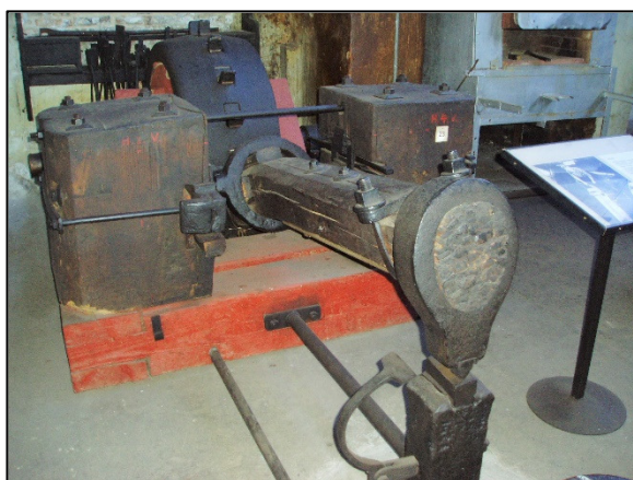
Hammer drevet af vandkraft
